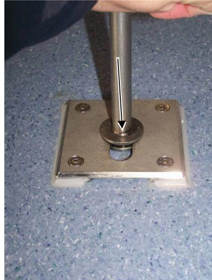
Dann den Stützfuß nach hinten ziehen, so dass dieser durch die beiden Teller am Stützfuß im schmalen Teil der Bodenverriegelung fixiert wird.
