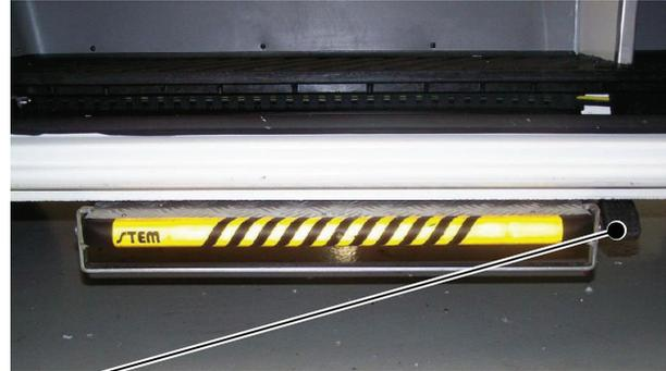
Die Trittstufe fährt durch Betätigung des Fußpedals aus.
