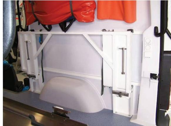
Die Trage muss mit dem Fußende nach vorne an der Nottragenhalterung gelagert werden.
