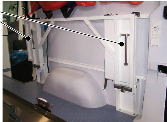
Den vorderen Stützfuß zuerst nach hinten ziehen (1) und dann den Fuß um 90 Grad nach oben drehen (2).
