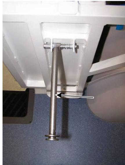
Den vorderen Stützfuß zuerst nach vorne ziehen (1) und dann den Fuß um 90 Grad nach oben drehen (2).
