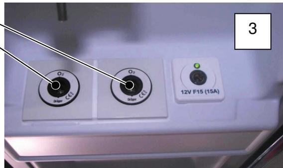
In dem vorderen Fach befindet sich ein Sauerstoff-Modul zur Beatmung von Patienten. Die Leitung ist mit einem Schraubverschluß angeschlossen.
