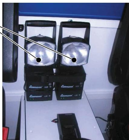
**Hinweis** Die Ladung des Akkus erfolgt nur, wenn der Motor vom Fahrzeug gestartet ist oder die 230V Außeneinspeisung eingesteckt ist.
