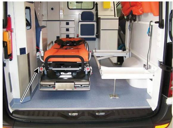
Für das Umsetzen der Trage vom Ambulanztisch auf die Nottragehalterung werden zwei Personen benötigt, eine am Kopfende und eine am Fußende. Die Person am Fußende muss während des Umsetzens auch im Fahrzeug stehen.
